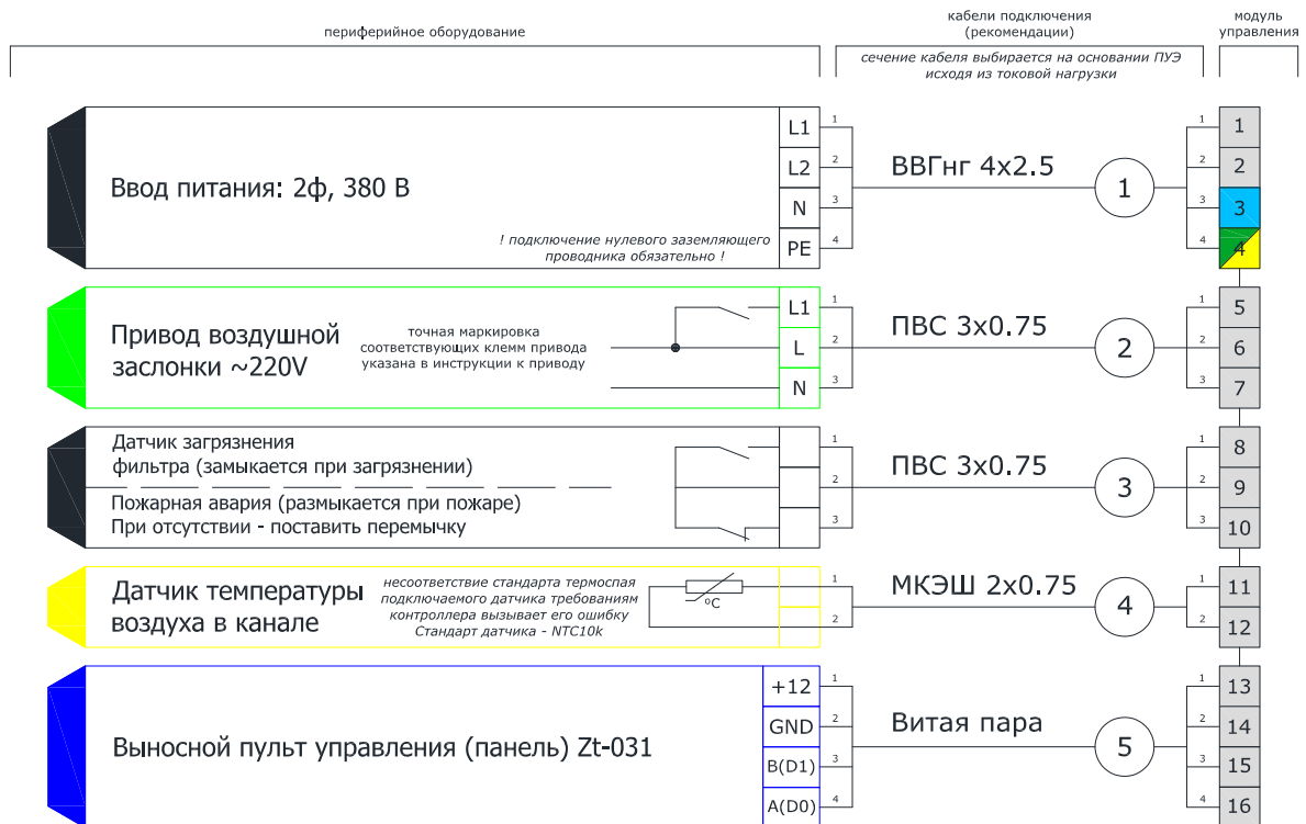
Рисунок 7 - Схема отходящих линий однофазные приточные установки с нагревателем мощностью до 3 кВт.
